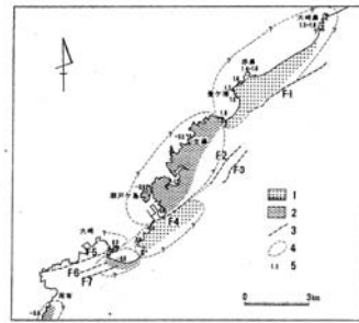
図 11 浜田地震時の隆起・沈降および隆起傾斜分布図 1. 隆起地帯、丸印は観測所の位置にともなう隆起が明らかになった地帯。他は今村 (1933) による。2. 沈降地帯; 今村 (1933) による。3. 隆起傾斜。4. 隆起した隆起・沈降のおおまかな範囲。5. 浜田地震による隆起・沈降; 隆起量は観測所の測定、沈降量は今村 (1933) による。
