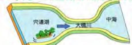
洪水を安全に流すため、中海・宍道湖の湖岸や大橋川に堤防を築きます。
