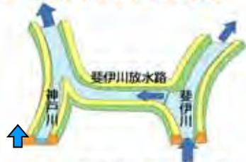
中海・宍道湖への洪水の流入量を減らすため、放水路を建設し斐伊川から神戸川へ洪水の一部を分流します。
