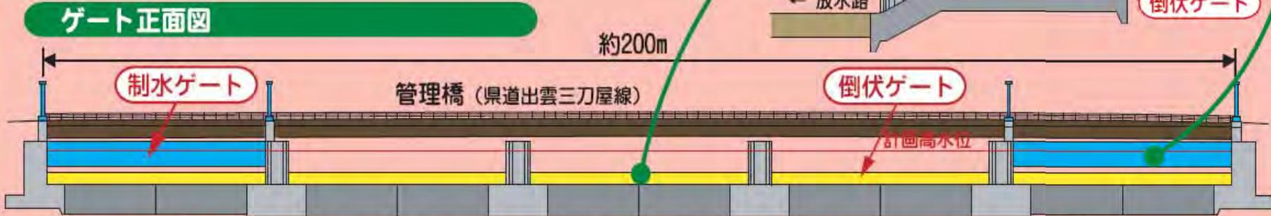
【分流施設計画諸元】 堰長：約200m、制水ゲート：2門、倒伏ゲート：5門、管理橋（県道出雲三刀屋線）：L=約200m、W=10.75m、沈砂池：1式、管理棟：1式
