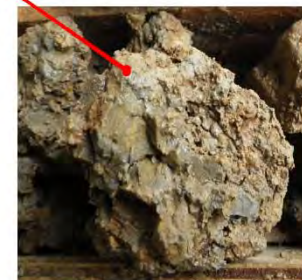
●深度10.1m 鏡肌は不明瞭だが破碎している
