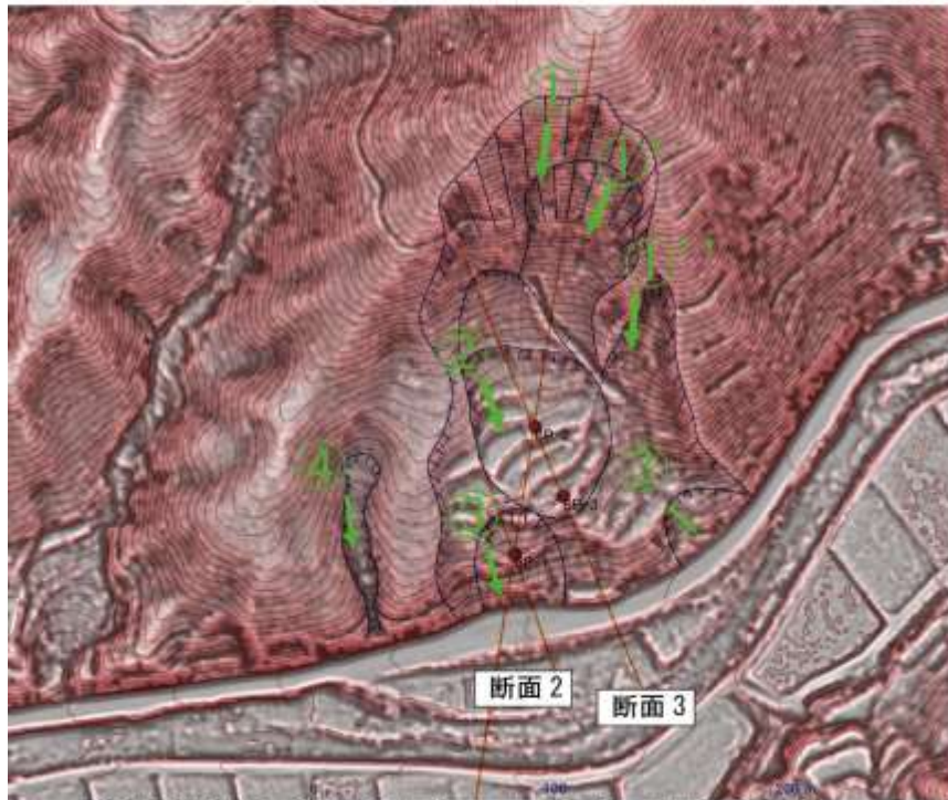
①岩盤崩壊、②崩積土すべり、③表層崩壊、④侵食
