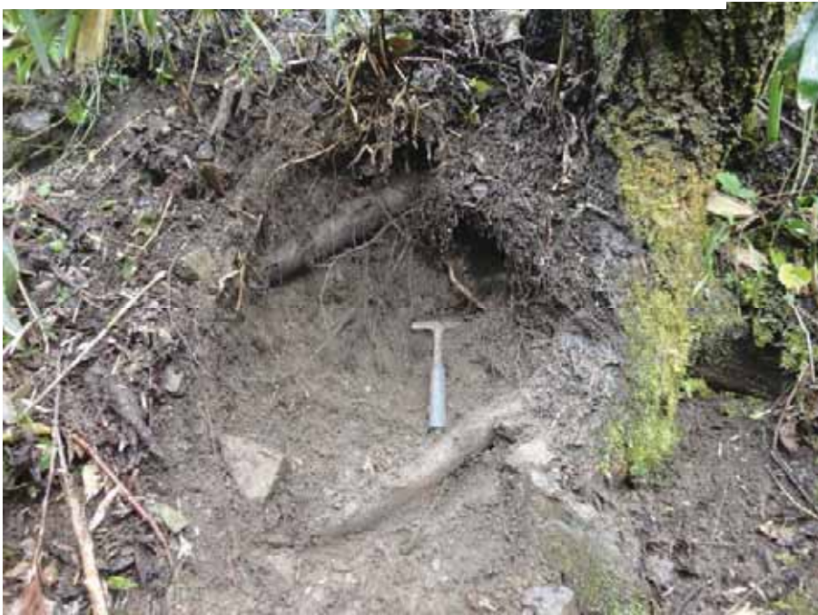
落石源の抜け跡近接(背後に樹根が成長していた)
