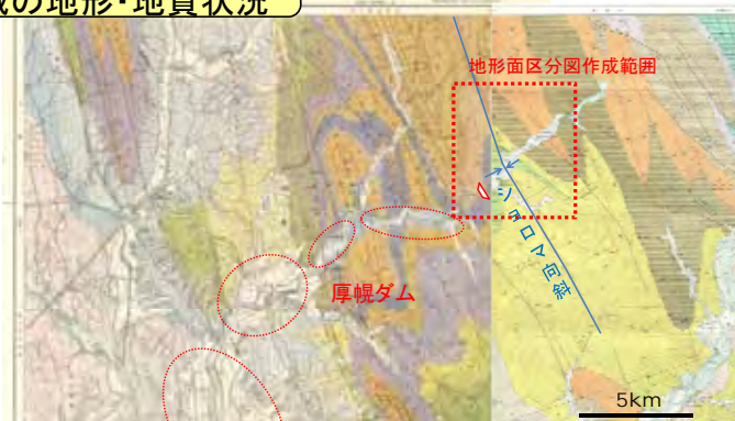
厚真町を中心とした地域は地質的には、主に新第三系堆積岩よりなる褶曲地帯で、地形的には細かく開析された山地(小起伏:標高400m以下)と丘陵地帯を主体とする。西寄りの部分では中期更新世以降の海成段丘が発達する。厚真川が北東から南西へ向かって流れ太平洋に注ぐが、その流域には沖積低地が膨脹を繰り返して分布する。狭くなった部分には、石狩低地東縁断層帯などの地質的構造線(帯)が通過することから、沖積低地の広がりは活構造(断層)に規制されている可能性がある。中～上流部では下位よりT1～T5の河岸段丘面の発達が顕著である。T5面(現河床からの比高30m前後～40m前後)で、その形成(離水)時期は5～6万年前で、それより古い(高い)段丘面は確認できず、地殻変動の進行により消失したものとと思われる。
