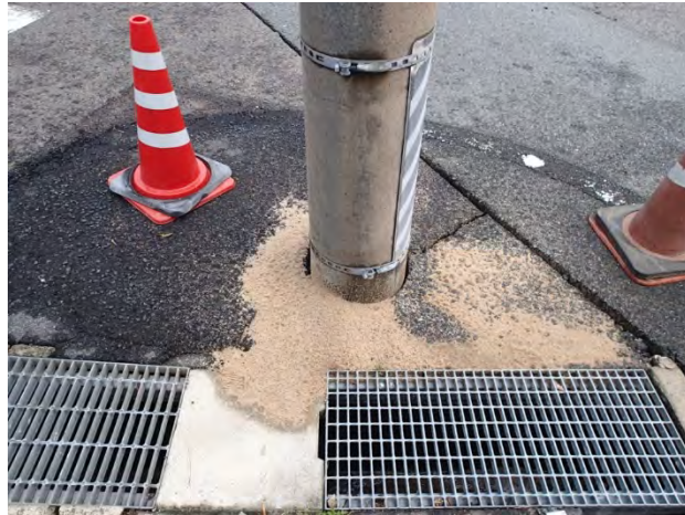
図7. 図6の地点のすぐ近傍で見られた噴砂. なお, この噴砂は非常に淘汰の良い細粒砂(中央粒径(D50):0.52mm, 細粒分含有率(FC): 2%, 淘汰度0.36)で構成されており, その性状から砂丘砂起源と判断される.
